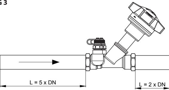
(DK) **FIG 3:** For at opnå en tilfredstillende verificering af flow skal reguleringsventilen skal installeres med en lige rørlængde på minimum 5 x rørdiameter før ventilen og 2 x rørdiameter efter ventilen.
